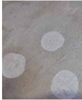
Figure 2 : Essai de rugosité « Hauteur de sable » sur un support béton. Un volume connu de sable de granulométrie définie est étalé sur le support. En fonction du diamètre de la tâche, le support doit être rendu plus ou moins rugueux.
